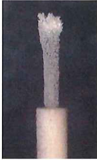
2万時間稼働した放電針先端
