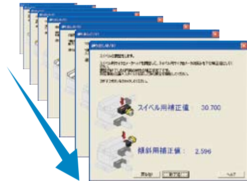
3軸調整テーブル使用時のFORMTRACEPAK ガイダンス画面
