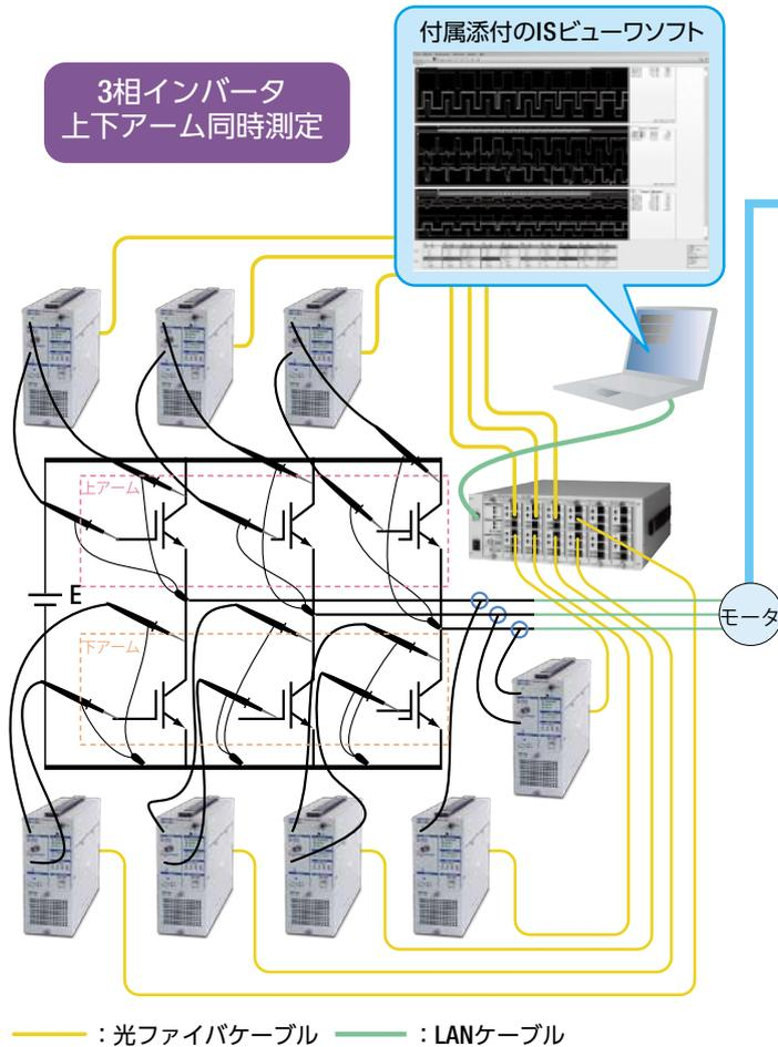
モータなどを駆動する3相インバータ(左図)の出力電圧波形は下図のようなパルス状の電圧波形となります。
