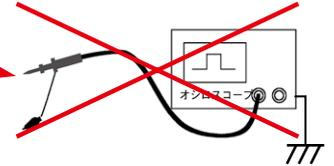
従来、このような測定には差動プロブが使用されてきましたが、同相除去比や耐同相電圧の制約により波形が乱れたり十分な測定帯域を確保するのが難しい場合があります。
