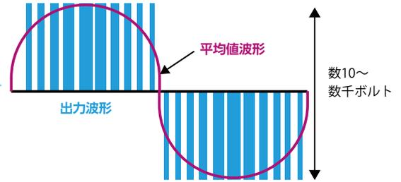
インバータの上アームのVceやVgeを測定する場合には、出力波形を基準にしてゲート電圧やコレクタ電圧を測定する必要がありますので、オシロスコープに付属するシングルエンド入力のプロブを使用することができません。
