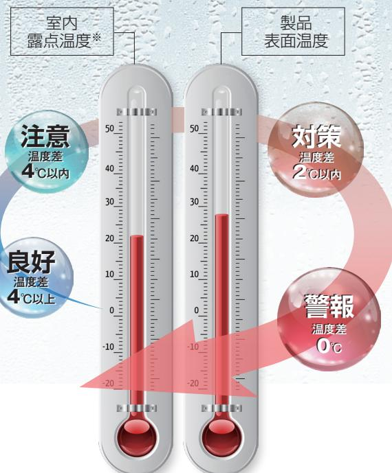
製品温度と露点温度との差における動作例
