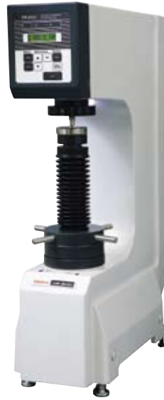
HR-320MS コードNo.963-231 ツインタイプ(ロックウェル/ ロックウェルスーパーフィシャル 兼用)硬さ試験機
