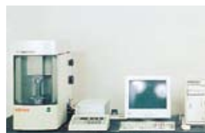
ロックウェル硬さ標準試験機 SHT-31 (本体、操作パネルを除き特別付属品)
