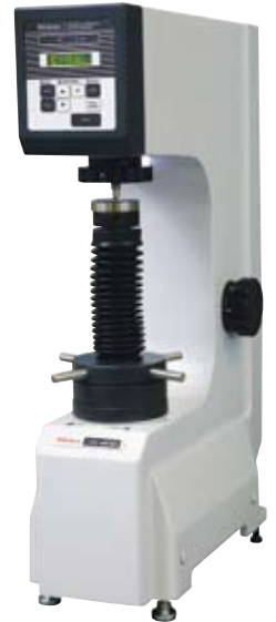
HR-430MS コードNo.963-241 ツインタイプ(ロックウェル/ ロックウェルスーパーフィシャル 兼用)硬さ試験機
