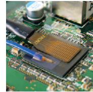
熱流センサと熱電対を両方設置
