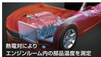
これからは熱流も測定 (熱電対+熱流センサ)
