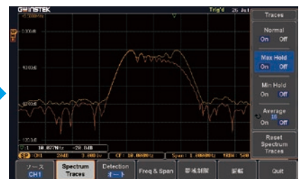
1MHz FM 変調波のスペクトラム
