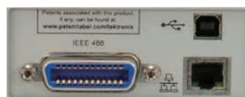
USB、LAN、GPIBポートを標準装備。さらにフロントのUSBポートからUSBメモリへのデータ・ロギングも可能です。
