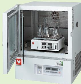
スライド式振とう器設置台 (オプション) と振とう器 MK161型の設置例
