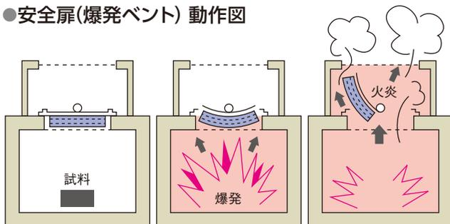
試験器内で爆発が発生した時、爆圧により天井部の断熱材を湾曲させ、上部の金網まで吹きとばし、爆圧を上部金網から外部へ逃がします。SPH(H)-402は背面の断熱材を湾曲させ、上部から爆圧を外部へ逃がします。
